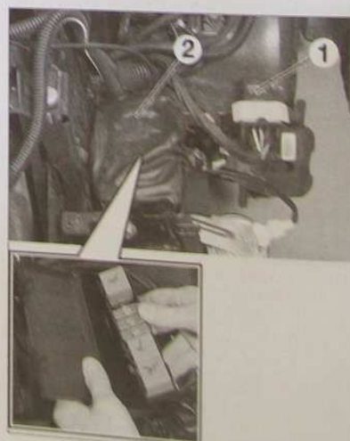
IMPLANTATION DES RELAIS DE CHAUFFAGE ADDITIONNEL ET DU BOÎTIER DE PRÉCHAUFFAGE
