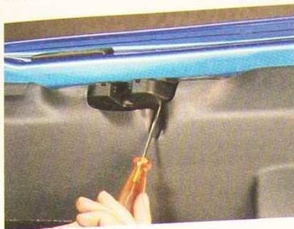
Déverrouillage de secours du coffre (vue volet supérieur ouvert).
