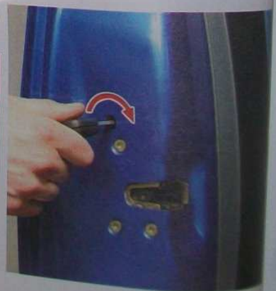
Verrouillage de secours de la porte conducteur.
