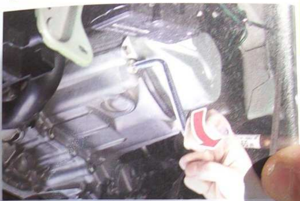
▲ Desserrage du bouchon de remplissage et de contrôle du niveau d'huile de boîte de vitesses (versions jusqu'au n° OPR 09785 *).
