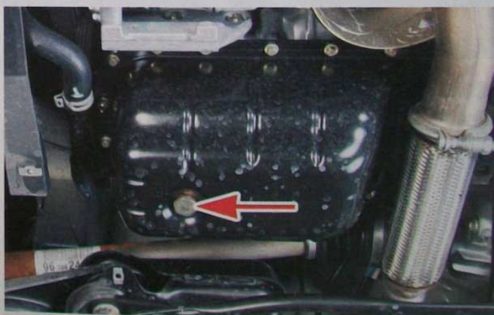
▲ Implantation du bouchon de vidange (moteur 1.4 HDi).
