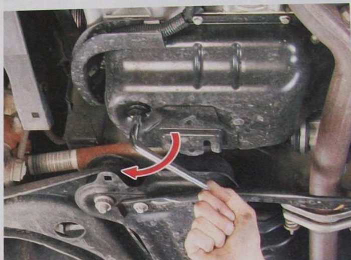
▲ Desserrage du bouchon de vidange (moteurs 1.1i et 1.4i).
