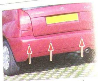
Implantation des capteurs d'aide au stationnement
