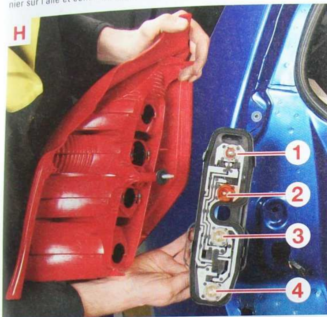
▲ Identification des lampes sur le porte-lampes d'un feu arrière. 1. Lampe de feu de stop et de feu de position - 2. Lampe de feu clignotant - 3. Lampe de feu de recul - 4. Lampe de feu de brouillard.
