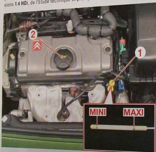
▲ Contrôle du niveau d'huile moteur sur la jauge (moteurs 1.1i et 1.4i). L'huile ne doit jamais dépasser le repère « maxi » ou descendre en dessous du repère « mini ».
